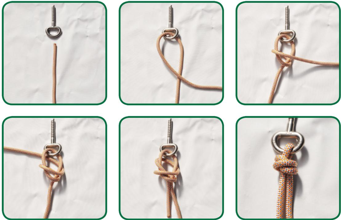
Fassknoten können am Ende der Cowtails eingesetzt werden um den Karabiner in Position zu halten und um eine Querbelastung zu vermeiden.
