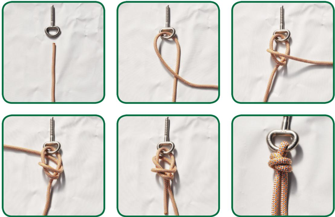
Fassknoten können am Ende der Cowtails eingesetzt werden um den Karabiner in Position zu halten und um eine Querbelastrung zu vermeiden.
